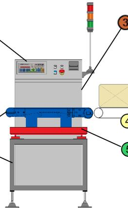
**Coffret électrique de commande** en acier ou inox incluant le ou les variateurs de vitesse, le transformateur, l'alimentation 24V, la protection des moteurs, le relaiage des sorties, l'arrêt d'urgence ainsi que le bornier de raccordement.
