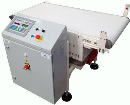
La Trieuse pondérale CW1-sac est un instrument de pesage à fonctionnement automatique destiné à contrôler le poids de tout produit vrac emballés en sac et convoyé automatiquement.
