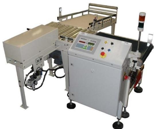
La Trieuse pondérale CW1 est un instrument de pesage à fonctionnement automatique destiné à contrôler le poids de tout produit convoyé automatiquement.
