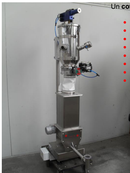
Chargeur par le vide avec doseur à perte de poids
