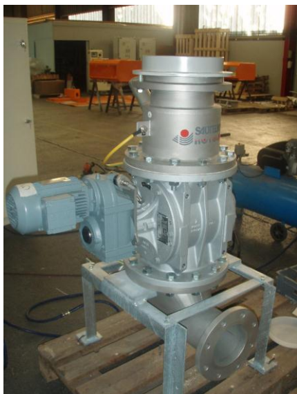
Écluse rotative pour transport pneumatique
