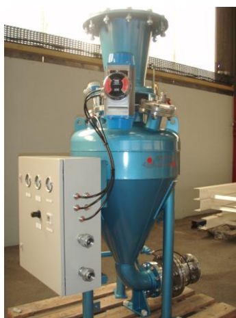
Coffret de commande
