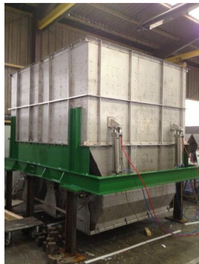
Bascule de circuit Trémie pesée + vanne à casque
